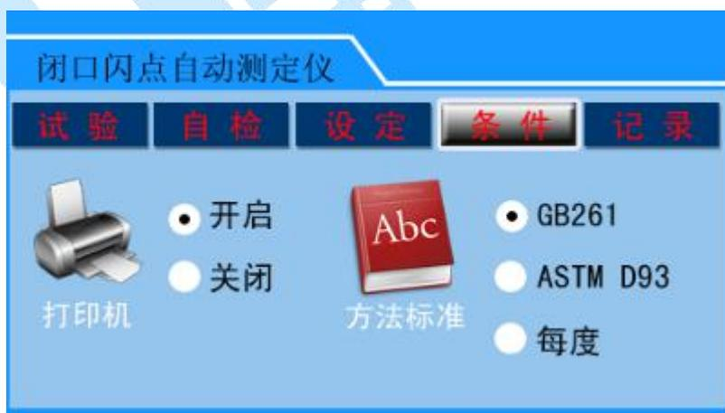
该界面用以设置打印机的开启、关闭及测试试样所符合的标准，采用的标准包括 GB261-2008 和 ASTM D93, 设定为“每度”时，测试试样开始后，在温度上升约 5℃时，每升高 1 度即开盖并点火一次，试验试样是否闪火，适用于并不
