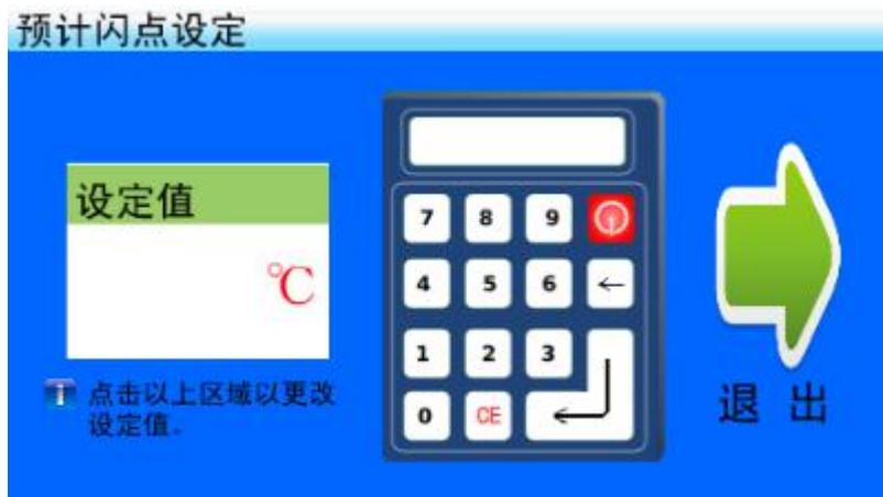
该界面下，点击“设定值”区域，键盘上方预计闪点设定值输入框处光标闪烁，可以输入数字，并按“←|”确认输入。要删除输入的数字，可以点击“←”。点击右上角的“X”，退出预计闪点设定界面。
