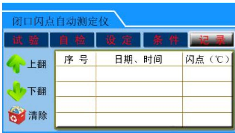
该界面显示已测试样的测定结果试验记录。“上翻”、“下翻”按钮用以翻页查询，“清除”按钮用于清空记录存储区的所有数据记录。
